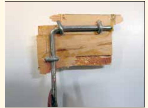
Med denna Infästning fjädrade huvudstället minimalt.
