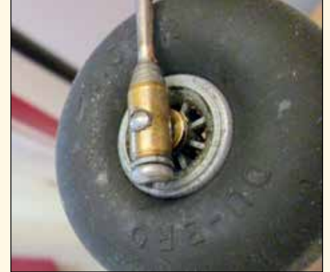
Nosstället var av 2,5 mm pianotråd utformat som en gaffel, vilket gör att hjulet inte ändrar riktning när det rullar efter många landningar. Hjulaxeln är fästad med ett litet rör och fastskruvad med M3 skruv.
