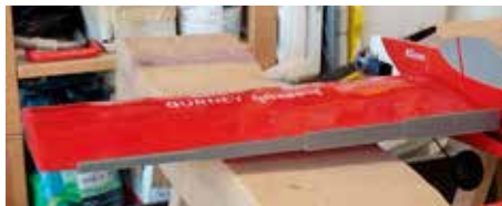
Höga GF vid kroppen och lägre GF ut mot vingpetsen.
