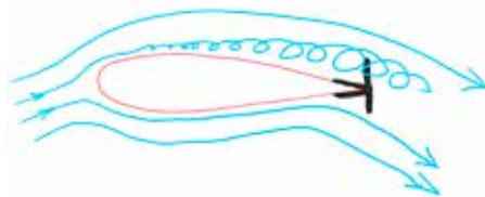
En simpel skiss i ett försök att förklara den dubbelsidiga GF'ens funktion.
