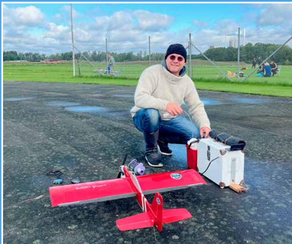
Johan Rasmussen flyger F2B stunt igen! Han har monterat gurney flaps på sin modell vilket märkbart förbättrat flygegenskaperna.
